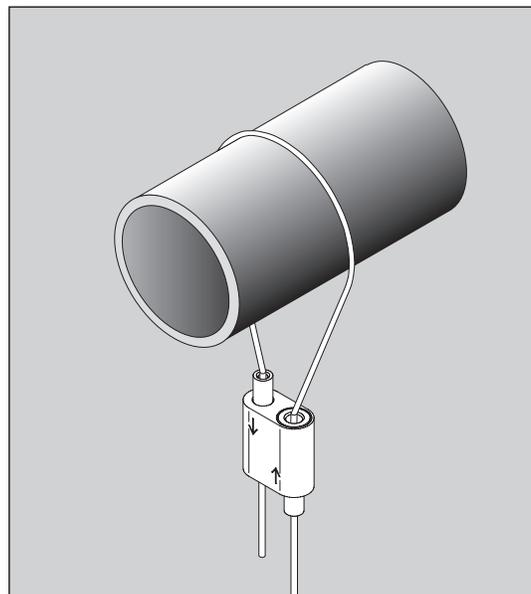
Pour terminer, insérer le câble dans le deuxième mécanisme autoagrippant, encore une fois en suivant le sens indiqué par les flèches.
