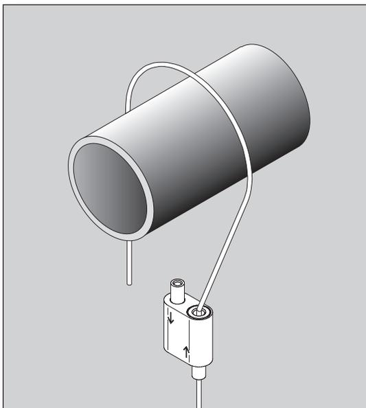
Faire passer le câble en boucle au-dessus de l'élément structurel afin de rejoindre l'attache.
