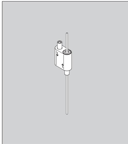
Suivre le sens des flèches pour l'insertion du câble.
