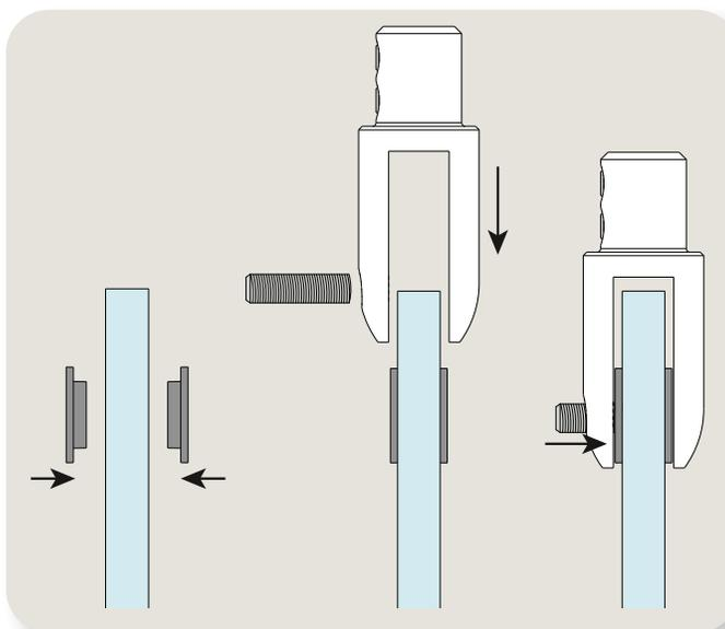
**2 Installation des attaches pour panneaux**
