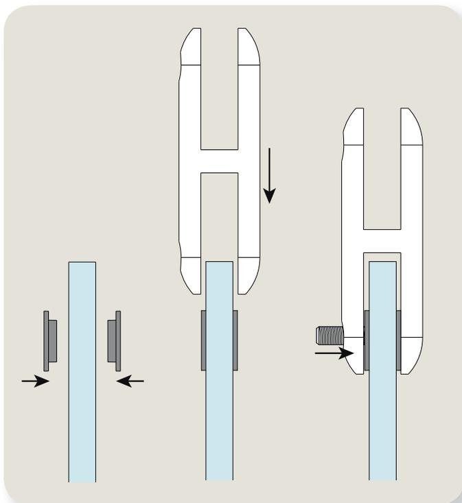
**2 Installation des attaches doubles sur le panneau inférieur**
